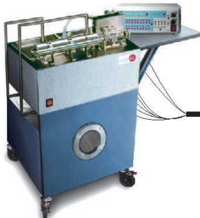
① Unit: ROUC. Reverse Osmosis/Ultrafiltration Unit
